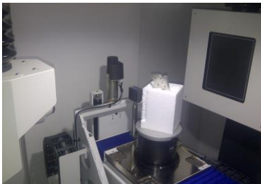
Rys. 1. Element pomiarowy wewnątrz komory tomografu METROTOM 800.
